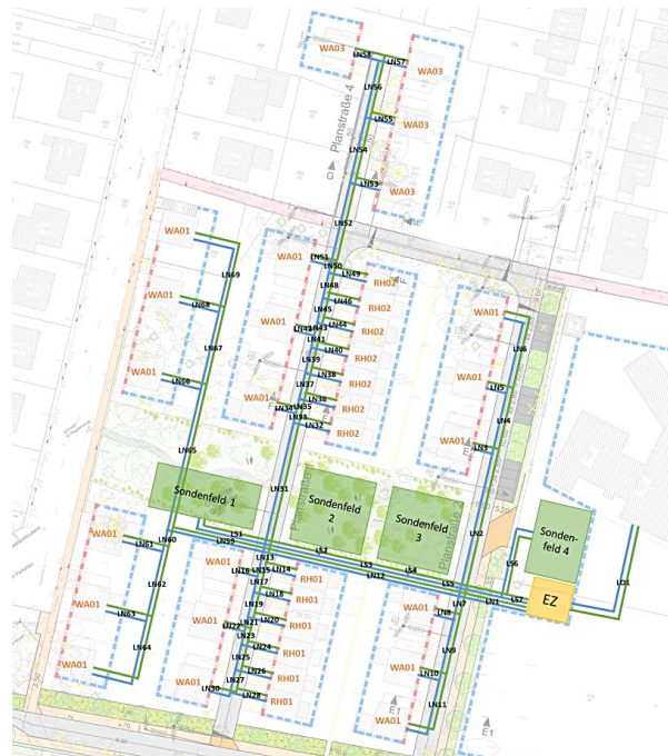
Abbildung 1: Netzschema des kalten Nahwärme-Netzes im Innenstadtquartier Dresden
